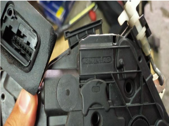
GAMBARAJAH: KERJA-KERJA BAIK PULIH POWER WINDOW DAN MENUKAR INNER LOG YANG BARU
