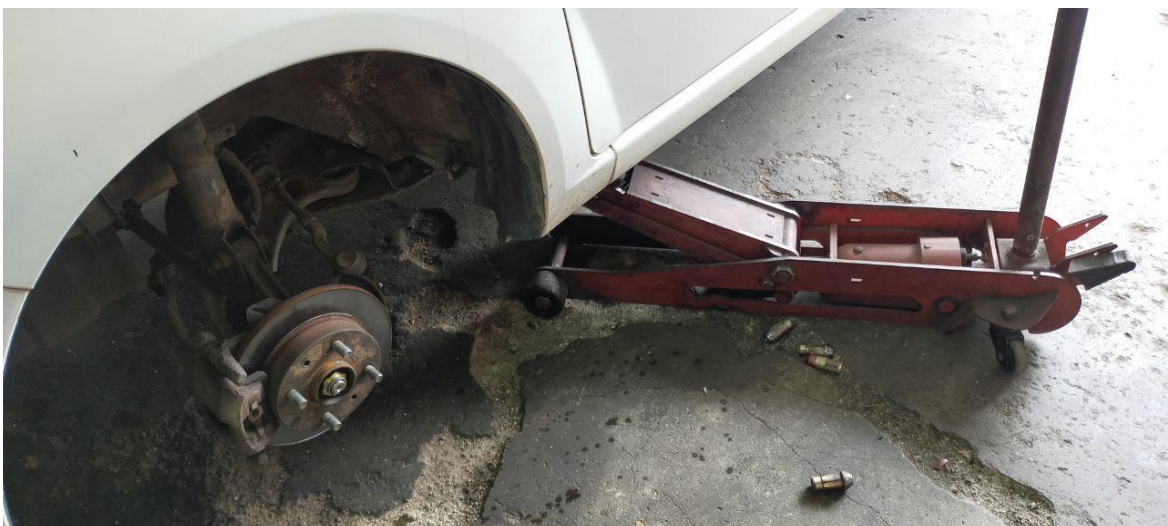
GAMBARAJAH: KERJA-KERJA MENUKAR TAYAR DAN BALANCING TYRE
