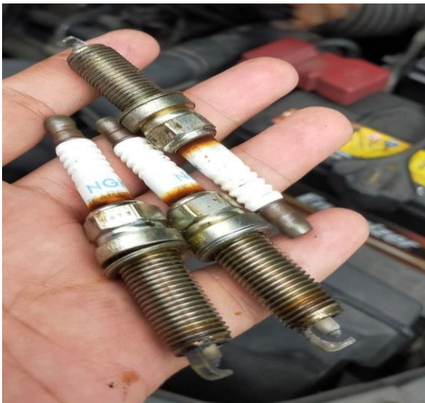
GAMBARAJAH: MEMERIKSA KENDERAAN MENGGUNAKAN SCANTOOL DAN PENUKARAN SPARK PLUG
