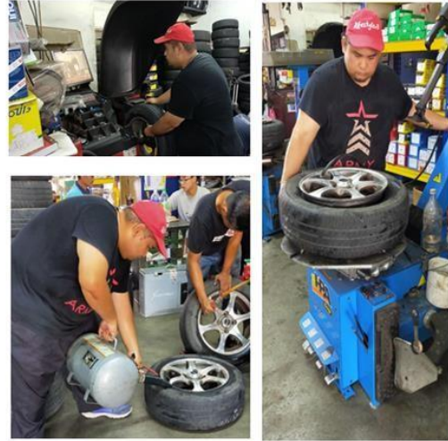
GAMBARAJAH: KERJA-KERJA MENUKAR TAYAR DAN BALANCING TYRE
