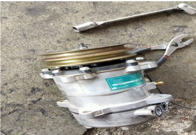
GAMBARAJAH: KERJA-KERJA PENUKARAN SPARE PART AIRCOND YANG TELAH ROSAK DIGANTI BARU
