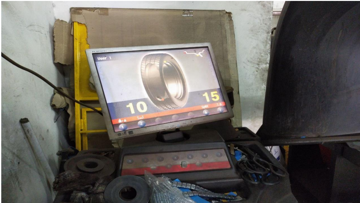
GAMBARAJAH: KERJA-KERJA MENUKAR TAYAR DAN BALANCING TYRE
