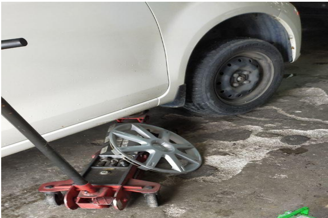
GAMBARAJAH: KERJA-KERJA SERVIS KENDERAAN DAN MENUKAR ABSORBER, SPRING BARU
