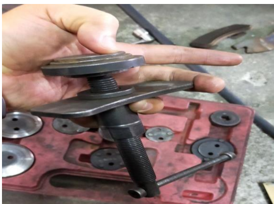
GAMBARAJAH: KERJA-KERJA MEMBUKA TAYAR DAN KERJA-KERJA MENUKAR BRAKE PAD BARU
