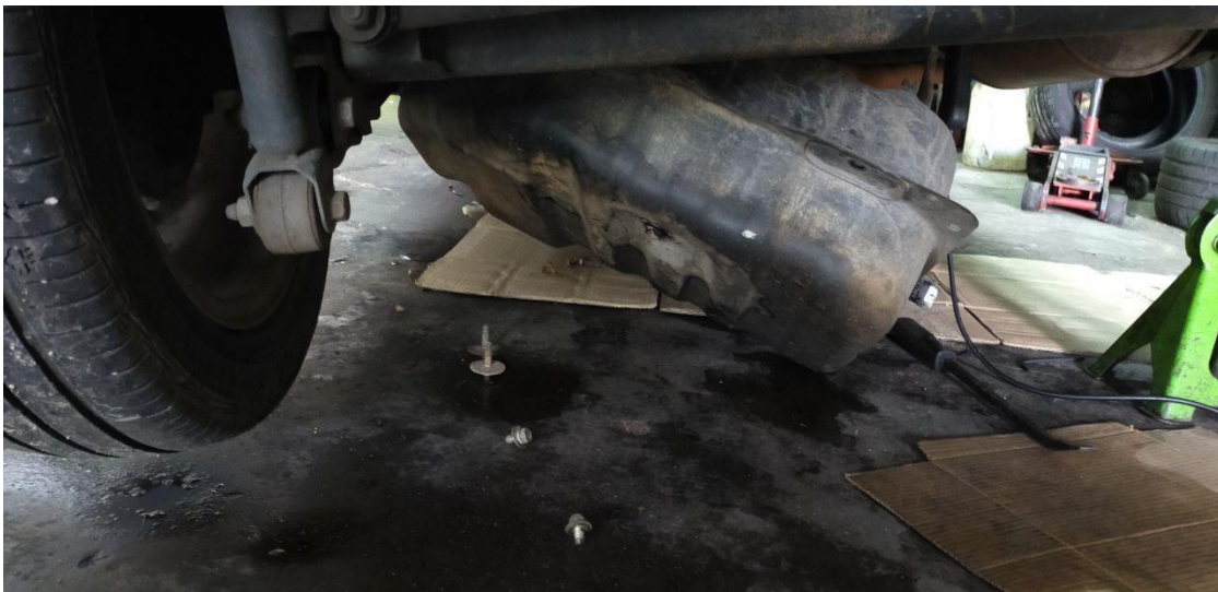
GAMBARAJAH: MEMBUKA BAHAGIAN FUEL PUMP DAN PROSES MENUKAR FUEL PUMP
