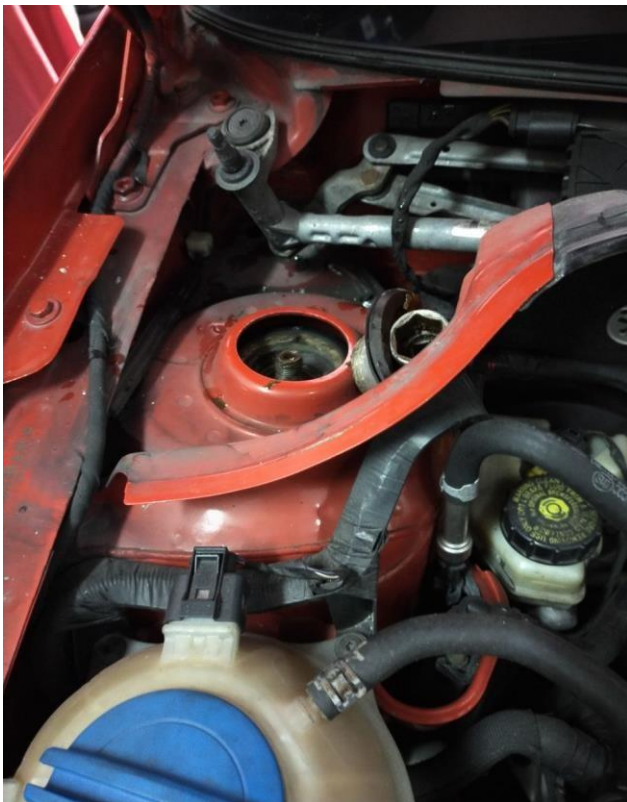
GAMBARAJAH: KERJA-KERJA SERVIS KENDERAAN DAN MENUKAR ABSORBER, SPRING BARU
